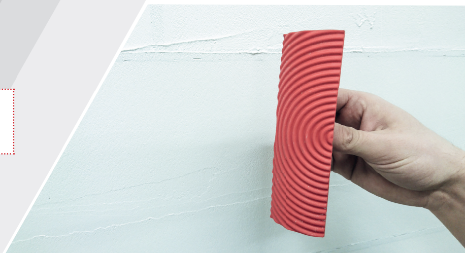
Stempel do słojuwania, do wykonania struktury deski.
